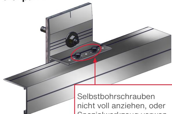
Selbstbohrschrauben nicht voll anziehen, oder Spezialwerkzeug verwenden, damit die Dilatation spannungsfrei möglich ist.
